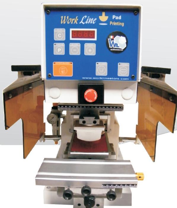
Macchine tampografiche desktop pneumatiche con base professionale a 1 colore con base shuttle. Hanno un sistema di blocco meccanico per lo scorrimento verticale del tampone, in modo da ottenere la massima precisione possibile. L'inchiostro è contenuto in una tazza che adotta un sistema avanzato per la tutela dell'ambiente e per il risparmio di inchiostro.
